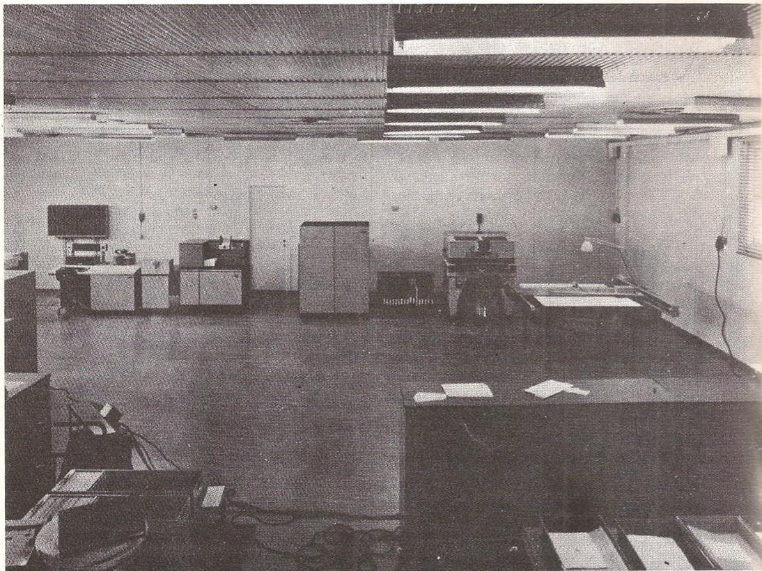
Lo Stereorestitutore Analitico mod. AP/C-3, il più moderno e versatile dei restitutori analitici prodotti dalla Ottico Meccanica Italiana per usi fotogrammetrici, è costituito da tre componenti principali: uno stereocomparatore di precisione, un tavolo di restituzione x-y ed un calcolatore elettronico digitale.
