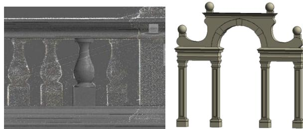
Figura 11. Modelli generici metrici di una colonna della balaustra, sovrapposta a nuvola di punti, e di un portale decorativo a Nord.
