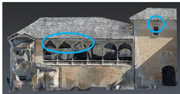
Figura 8. Prospetto Sud: criticità della nuvola fotogrammetrica
