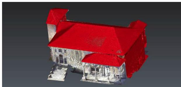
Figura 9. In rosso le parti mantenute dalla nuvola fotogrammetrica, in RGB la nuvola laser scanner.
