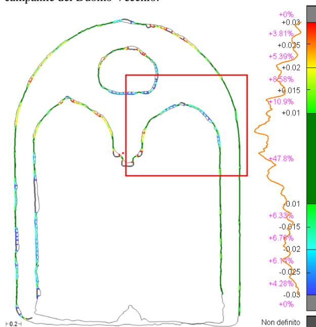
Figura 8. Confronto tra sezioni verticali, che permette di analizzare puntualmente gli scostamenti tra i due modelli. Il riquadro indica il dettaglio rappresentato in Figura 9.
