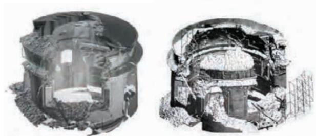
Figura 15. Rilievo laser scan del tiburio e inserimento dei telai metallici per il ripristino della continuità dei setti crollati (Gruppo di Lavoro NCP, S. Grimaz coord., 2010a).
