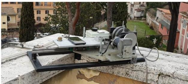
Figura 4 Tavola vibrante utilizzata nell'esperimento.
