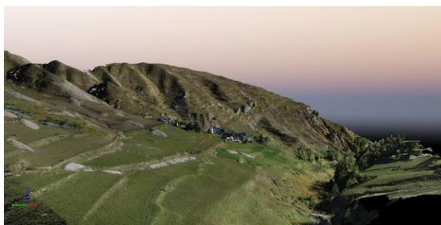
Figure 8. Vista 3D del modello da dati UAV texturizzato mediante l'ortofoto della Valletta di Ferrere.
