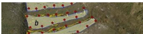
Figura 15. Quattro aree campione (*a, b, c, d*) per comparare i confini dei terrazzamenti individuati con il metodo semi-automatico B1 (poligoni blu), automatico (poligoni gialli) e punti misurati con tecnica GPS/RTK.
