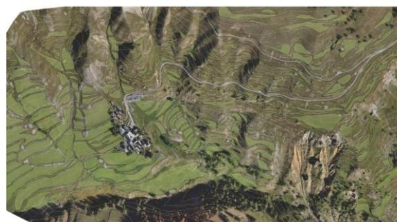
Figure 11. Dataset finale della perimetrazione dei poligoni dei terrazzamenti sovrapposti all'ortofoto derivate da dati UAV.
