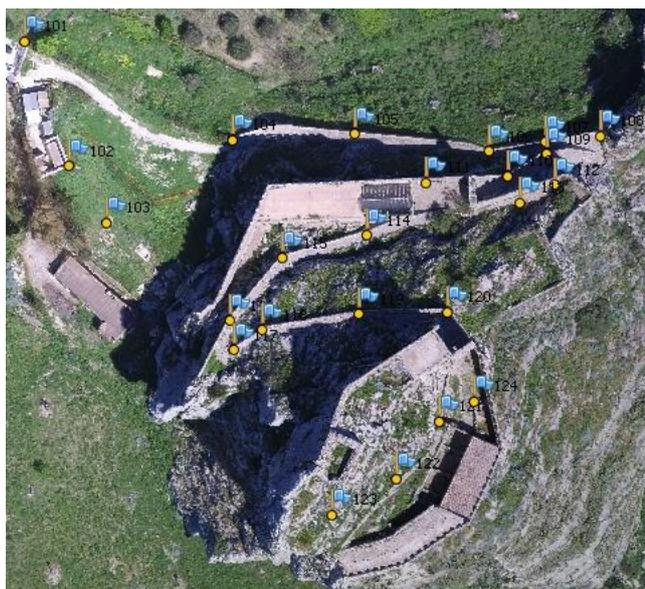
Figura 11. L'ortofoto del castello, con l'indicazione dei target acquisiti.
