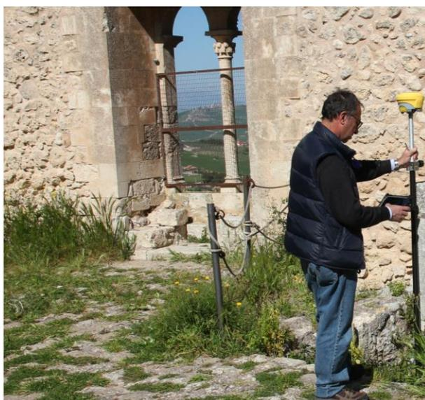
Figura 10. Il rilievo dei target con il ricevitore GNSS.
