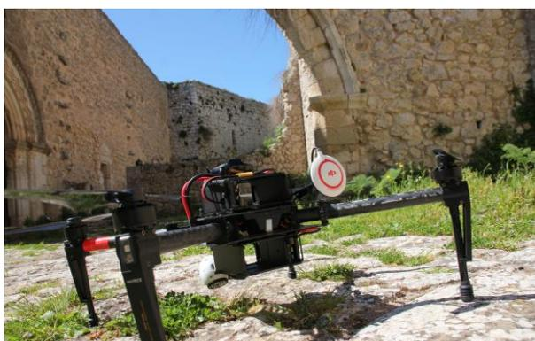
Figura 7. L'APR DJI Matrice 100 utilizzato per il rilievo aereo.
