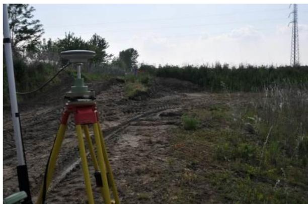
Figura 3. Ricevitore GNSS posizionato sul vertice 1000
