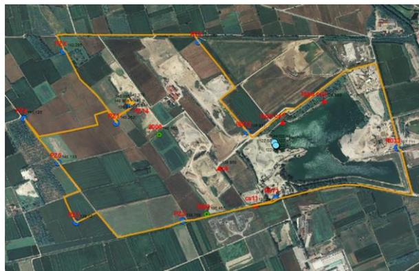
Figura 4. La linea di livellazione seguita sovrapposta all'ortofoto 2009
