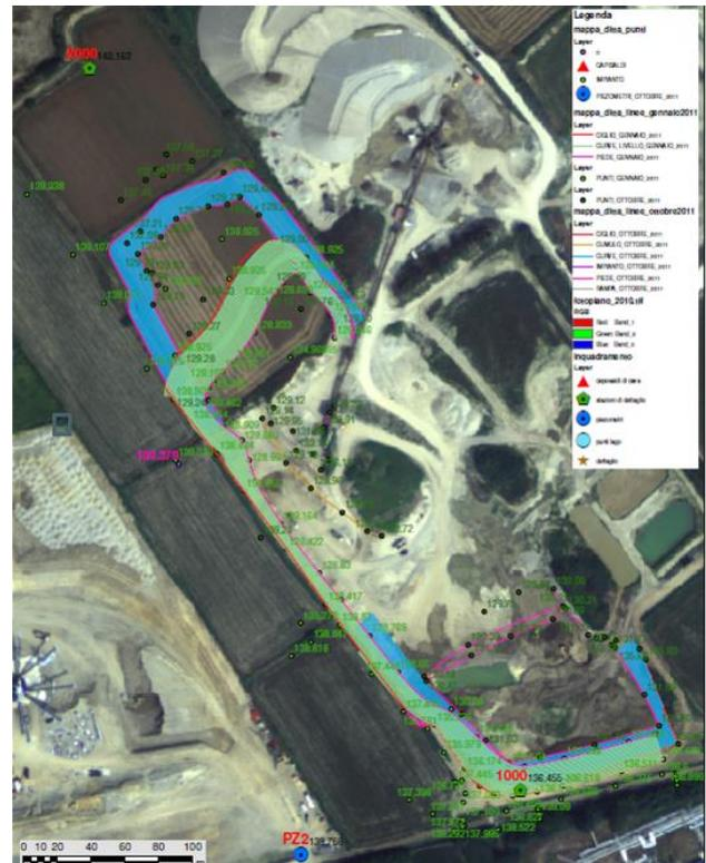
Figura 9. Variazione del piano di coltivazione di cava (sinistra) e sua sovrapposizione con ortofoto (a destra)
