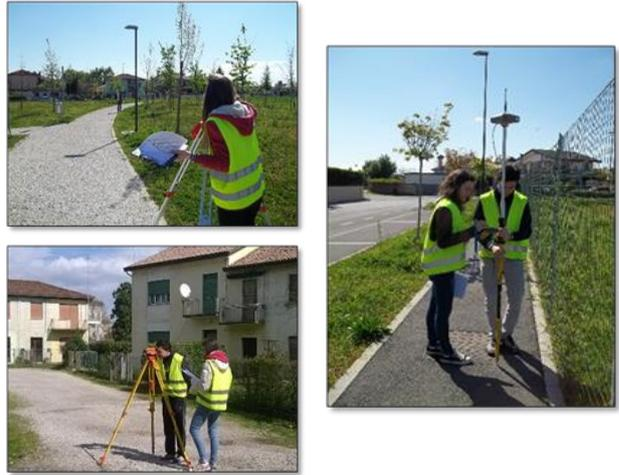
I rilievi sono stati georeferenziati entro il sistema cartografico UTM-WGS84, grazie all'impiego del GPS ed è stata realizzata una restituzione cartografica dei punti misurati.
