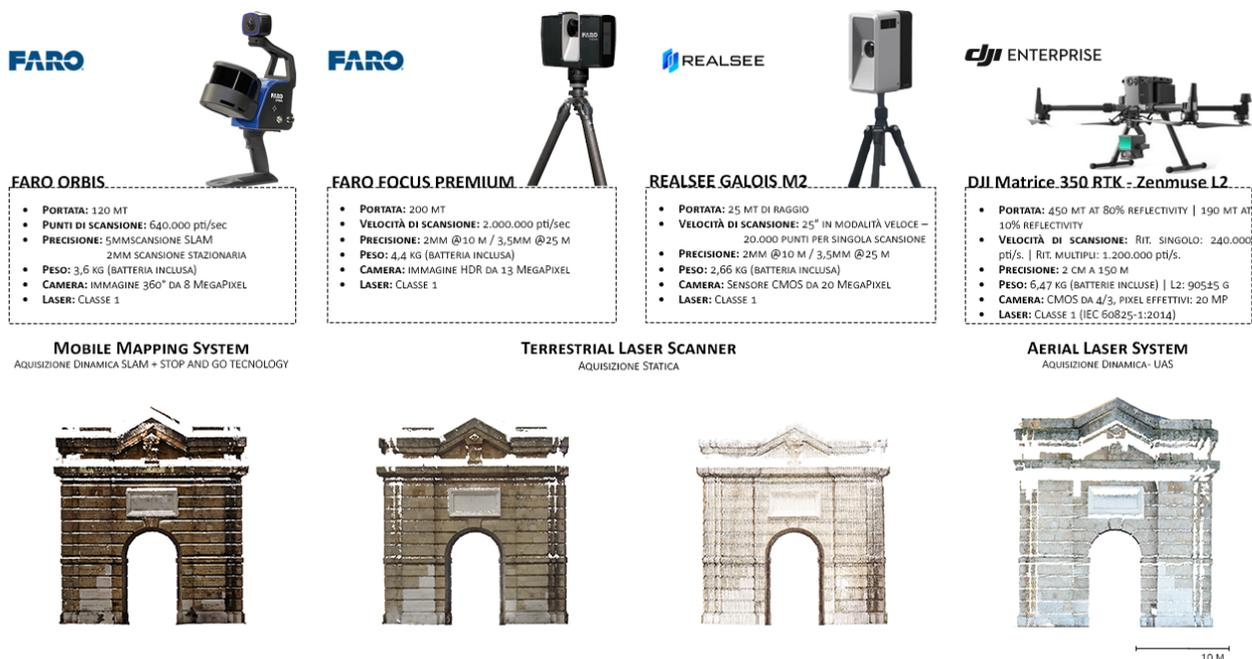
Figura 1. Caratteristiche tecniche delle strumentazioni impiegate per il rilievo. Nuvola di punti densa. Dettaglio: Porta Pia, lato nord.
