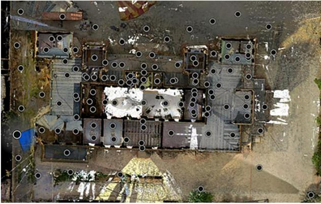
Figura 4. Vista dall'alto delle posizioni delle scansioni TLS.
