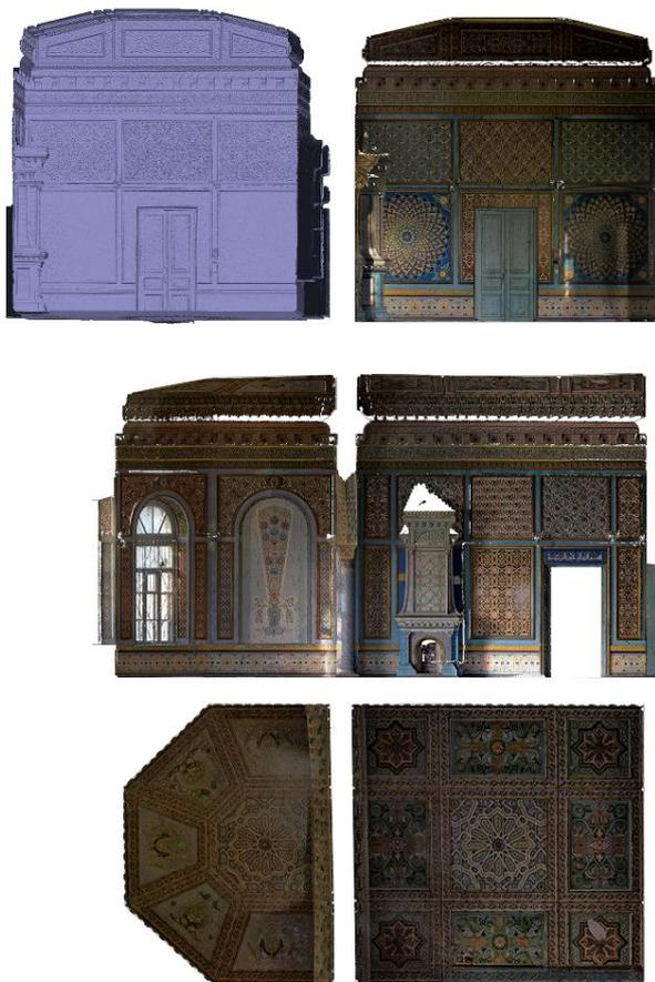
Figura 10. Ortofoto ad alta risoluzione in scala 1:20. Esempio della Sala D: mesh e ortofoto
