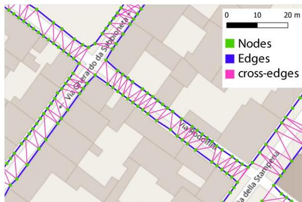
Figura 4 Una porzione della città di Sabbioneta, i punti verdi sono i nodi (*nodes*), che rappresentano i segmenti di marciapiede, le linee blu sono i collegamenti (*edges*) tra i nodi lungo il percorso del marciapiede, e le linee viola sono i collegamenti che attraversano la strada (*cross-edges*),
