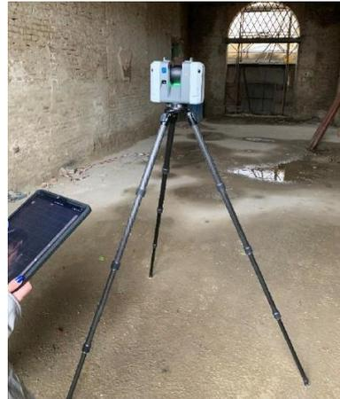
Figura 3. Rilievo con Leica RTC360.
