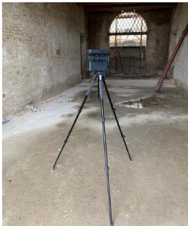
Figura 2. Rilievo con Matterport Pro2.
