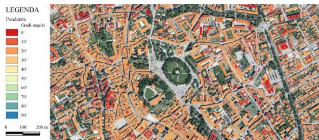
Figura 1. Rappresentazione delle pendenze delle coperture.
